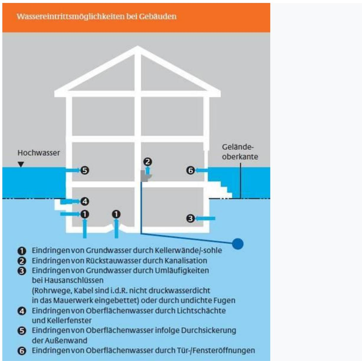
Abbildung 1: Wassereintrittsmöglichkeiten bei Gebäuden, Quelle: Hochwasserschutzfibel BMVBS (2010)
