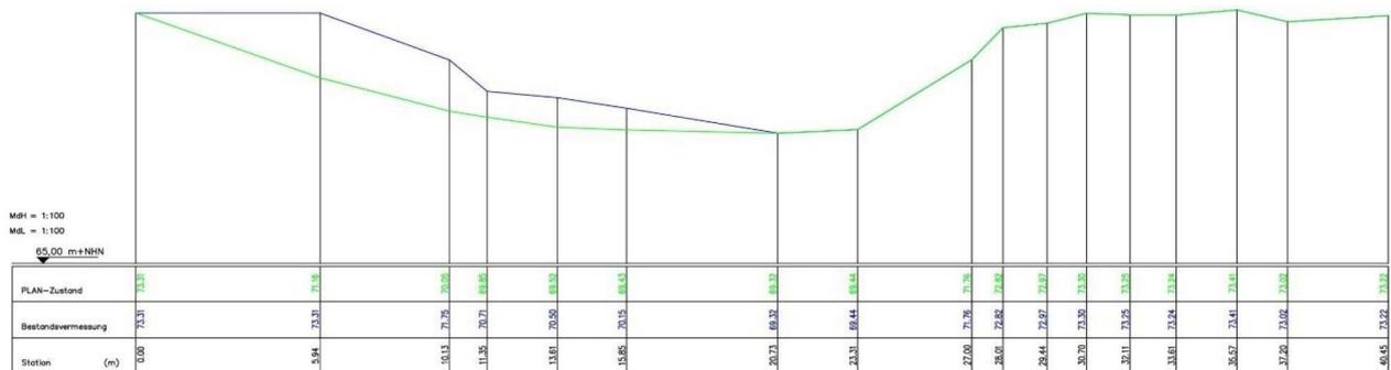
Abbildung 6-2: Exemplarische Darstellung der abzutragenden Fläche zwischen blauer und grüner Linie an Querprofil 4
