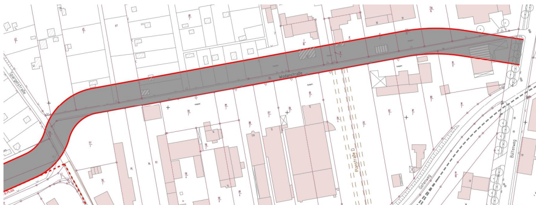
Grafik 8: Variante Trassenführung Wodanstraße: Anhalten der südlichen Grenze, kein Abriss Halle auf Flurstück 93, Abriss Wohngebäude Wodanstraße 35, Teilabriss Gewächshaus Gärtnerei, Erhalt des Gebäudes des Eckgrundstückes des Landes Niedersachsen mit Abstand zum Gebäude
