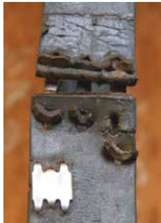
Abb. 123 -125: Ausschnitte von den Maschinen / Verbindungsstelle eines Antriebsriemen, 2006
