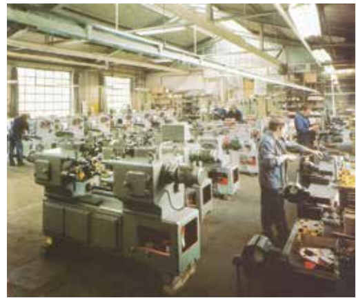
Abb. 95: Endmontage von Bördel- u. Falzautomaten zur Herstellung von Farb- und Aerosoldosen, 1987
