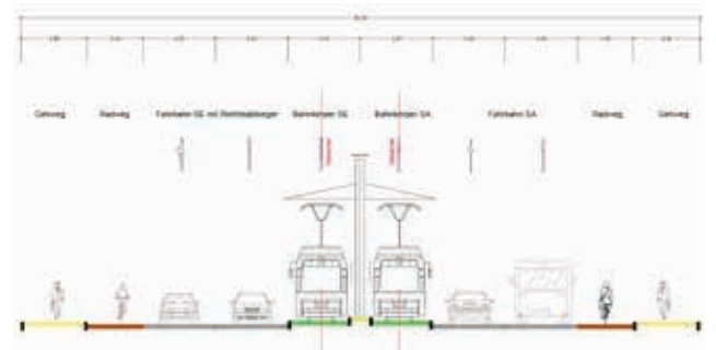
Systemquerschnitt Heinrich-Büssing-Ring West o.M.
