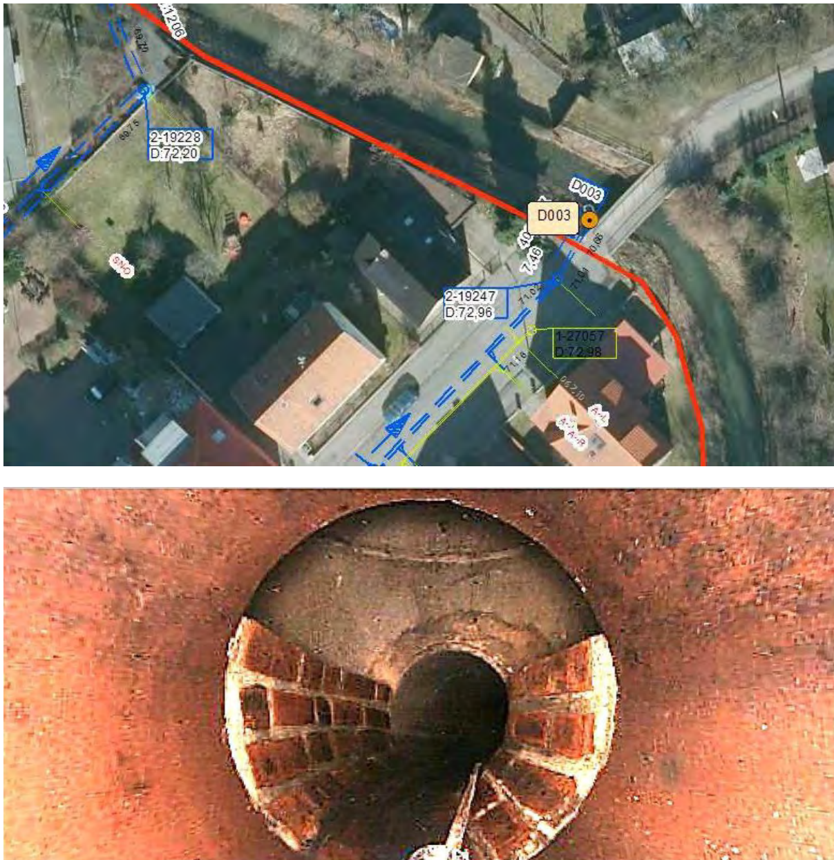
Abbildung 4-12: Oben: Ansicht der Einleitstelle D003 mit dem zugehörigen Kanalnetz (blau), Unten: Blick in den Schacht 2-19247
