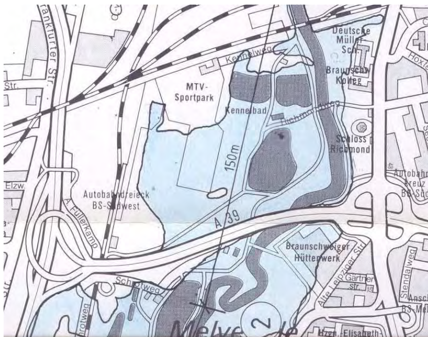
Abbildung 4-5: Okerhochwasser 1994 – überschwemmte Flächen (Auszug)
